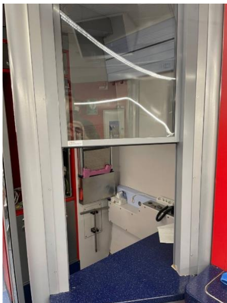
Upprustning Coradia X62. Bild 5: Polerade bänkskivor och ny glaslucka till bistro. Bild 6: Ventilation kompressor bistro.
